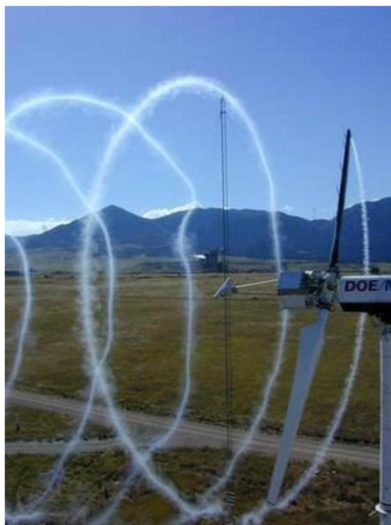
**Photographie 49** Effet de sillage derrière une éolienne bi-pale visualisé à l'aide d'un traceur fumée
